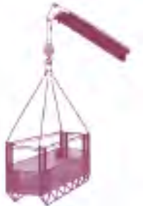
Εικ. 5: Ανάρτηση από 4 συρματόσχοινα με συντελεστή ασφάλειας 5:1
