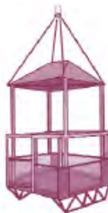
Εικ. 3: Καλιάθι με οροφή και ανάρτηση από τέσσερα σημεία με δακτύλιο
